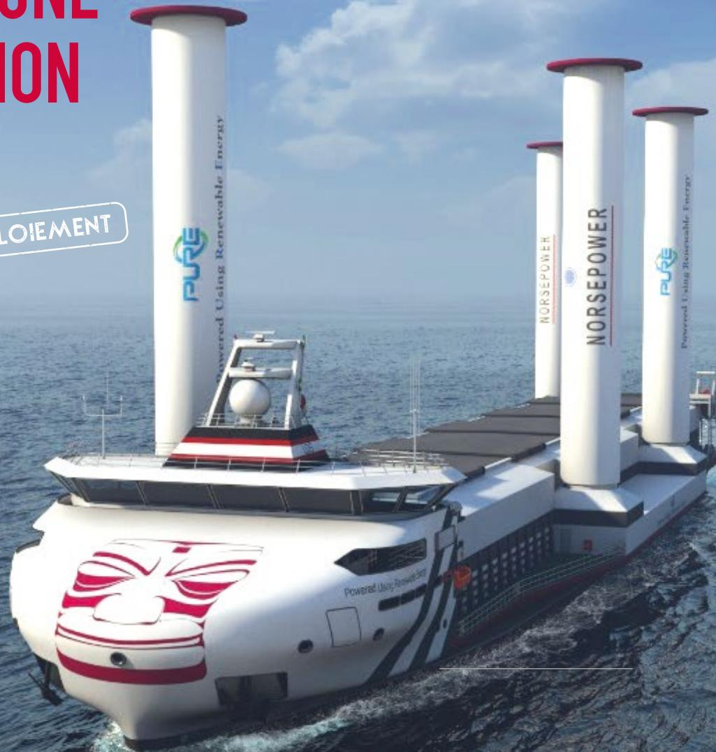
“On profite du vent réel et du vent apparent pour générer une poussée supplémentaire.”
