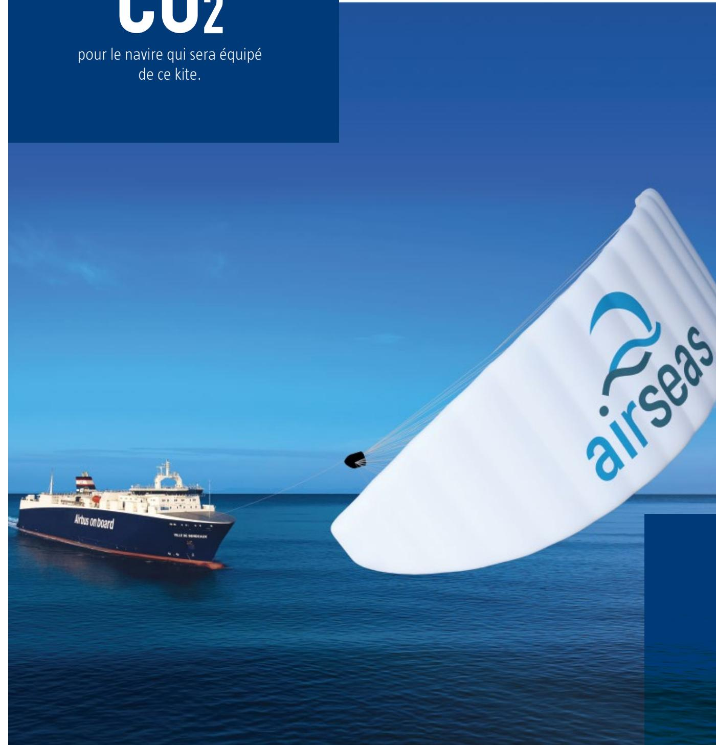
SeaWing est un cerf-volant (kite) automatisé, basé sur la technologie parafoil, utilisé pour remorquer des navires commerciaux. Seawing analyse également une multitude de données complexes en temps réel et s'adapte de manière autonome aux conditions du moment afin d'optimiser les performances du navire tout en garantissant une sécurité maximale. L'économie en carburant attendue réduira d'autant l'empreinte environnementale en CO<sub>2</sub> pour le navire qui sera équipé de ce kite.
