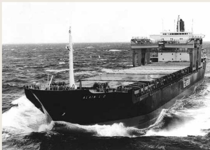
« L'idée pour le moins brillante de Kristian Gerhard Jebsen était d'axer les services maritimes sur des cargaisons unitisées et de construire des navires dotés de cales à angle droit, en forme de boîte. De plus, l'ouverture totale des panneaux de cales facilitait
