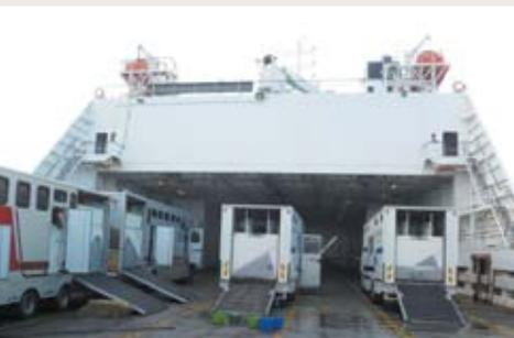
Les remorques ont été spécialement aménagées pour le transport : toit ajustable, fenêtre à l'avant pour faciliter le chargement, plancher surbaissé, caméras de surveillance 24h/24...
